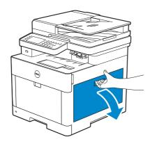
2 Empuje hacia abajo el cierre para soltar la caja de tóner residual de la impresora.
