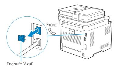
**3** Conecte el cable de línea de un teléfono o un contestador en el conector del teléfono de la parte posterior de la impresora. Conecte el otro extremo del cable en un teléfono o un contestador automático externo.
