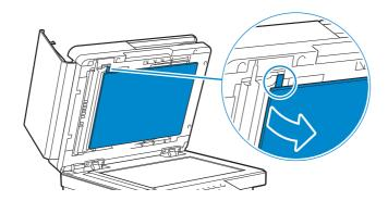
**3** Retire el documento del interior de la cubierta del conducto del DADF tirando de él con cuidado hacia la izquierda.
