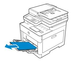
**2** Agarre ambos lados de la cubierta del MPF y tire el MPF fuera de la impresora.
