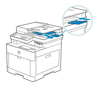
**3** Retire todo el papel de la bandeja de salida y vuelva a colocar la extensión de la bandeja de salida.
