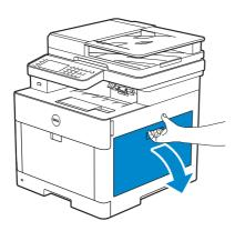
2 Empuje hacia abajo el cierre para soltar la caja de tóner residual de la impresora.
